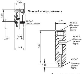
Переходник плавкого предохранителя
