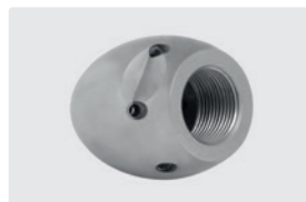
3/4" IG. 6x 75° +1x 0°. 30-100 л/мин. Для R 120-250 мм. Наружный Ø 50 мм. 567 г.
