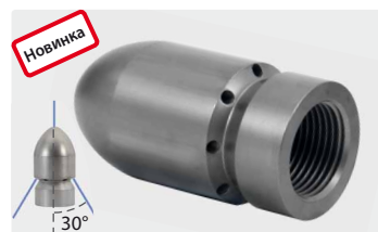
1" IG. Наружный \varnothing 48 мм. 8 отверстий сзади, с фронт. отверстием
