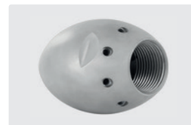
1" IG. 8x 75° +1x 0°. 100-250 л/мин. Для R 150-300 мм. Наружный Ø 62 мм. 1.265 г.
