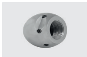
1/2" IG. 6x 75° +1x 0°. 30-100 л/мин. Для R 100-200 мм. Наружный Ø 40 мм. 281 г.
