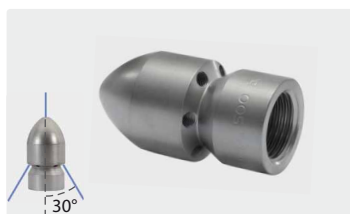
1/2" IG. Наружный \varnothing 30 мм. 6 отверстий сзади, с фронт. отверстием
