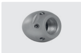
3/8" IG. 6x 75° +1x 0°. 25-70 л/мин. Для R 75-150 мм. Наружный Ø 35 мм. 207 г.
