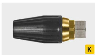
M18 IG. Угол распыления 20°. 100 - 250 bar. Макс. 100 °C
