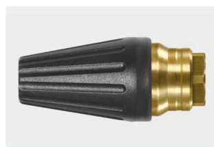
1/4" IG. Угол распыления 20°. 200 - 400 bar. Макс. 100 °C
