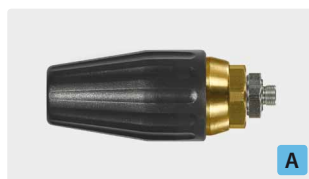
1/8" AG. Угол распыления 20°. 100 - 250 bar. Макс. 100 °C
