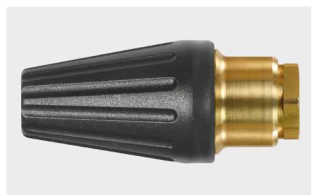
1/4" IG. Угол распыления 20°. 120 - 250 bar. Макс. 100 °C
