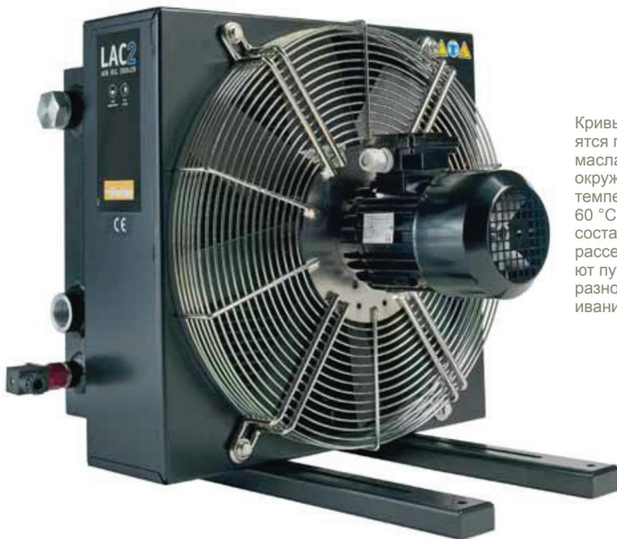
Кривые теплорассеивания строятся по значениям температуры масла на входе и температуры окружающего воздуха. Разность температур при температуре масла 60 °С и температуре воздуха 20 °С составляет 40 °С. Общее теплорассеивание установки определяют путем умножения полученной разности на величину теплорассеивания в кВт/°С.
