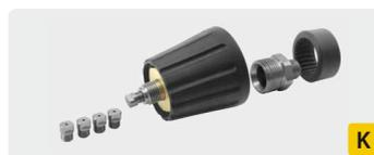
Ограничитель потока для уменьшения потока воды. Вкл. адаптер и дозир. форсунки (1,0, 1,1, 1,2, 1,3, 1,4)
