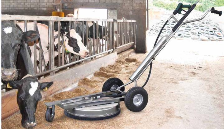
Мойщик поверхностей со складывающейся направляющей ручкой. Вращ. соед. с уплотнением из закаленного металла. Направляющее колесо (30 мм) для движения по решетчатым полам. 2 очень больших задних колеса. Требуется 2 форсунки 1/4" AG. Макс. 1.800 л/час / 120 °C
