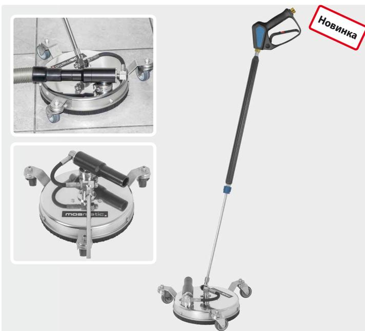
Мойщик поверхностей AQUA с всасыванием. Комплектно с интегрированной системой самовсасывания, пистолетом и форсунками. Всасывание: 40 мм. Рассчитан на 150 бар / 15 л / мин. Узел всасывания из черного анодированного алюминия всасывает грязную воду по принципу Вентури через систему сдвоенного корпуса. Грязную воду можно отвести через самый обычный всасывающий шланг. Макс. 275 бар / 120 °C.
