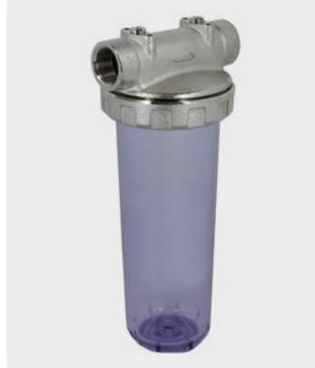
Из 3-х частей. Заглушки для выпуска воздуха. Головка из никелир. латунь. Колба из пластм. Макс. 15 bar / 40 °C
