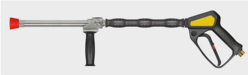
3/8" IG. Нерж. сталь. Копье с дальним выбросом 350 мм с изоляцией ST-29 Cool & Compact 330 мм, пистолетом ST-2300, боковой ручкой и защитой форсунки из пластмассы без форсунки. Макс. 280 bar / 45 л/мин / 100 °C
