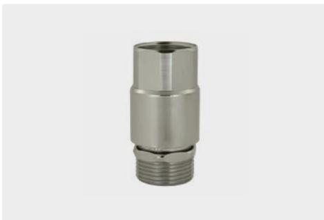
Хромир. латунь. В соответствии с DIN 19884 и DIN EN 1717. Чтобы при избыточном давлении в водопроводе моющее средство не попало в систему водоснабжения питьевой водой. Предписано при прямом подключении насоса к водопроводу.
