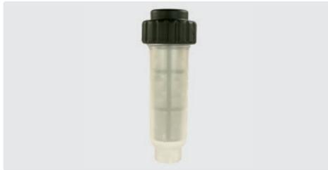
Комплектно с фильтрующим моющимся элементом (нерж. сталь и пластмасса). 50 микрон. Макс. 6 bar / 50 л/мин / 60 °C
