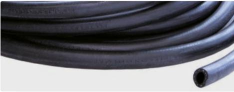
Черные внутренняя и внешняя оболочки. Промыш. исполнение для воды и сжатого воздуха. Износо- и озоностойкий. Разрывное давление > 60 bar. Макс. 20 bar. -10 °C - +60 °C
