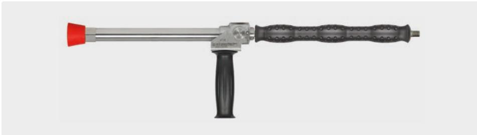
1/4" AG. Нерж. сталь. Копье с дальним выбросом 350 мм с изоляцией ST-29 Cool & Compact 330 мм, боковой ручкой и защитой форсунки из пластмассы без форсунки. Макс. 280 bar / 130 л/мин / 100 °C
