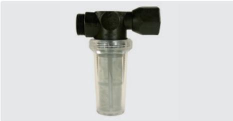
Комплектно с фильтрующим моющимся элементом (нерж. сталь и пластмасса). ⊓ 95 мм ⊓ 112 мм. Макс. 6 bar / 50 л/мин / 60 °C
