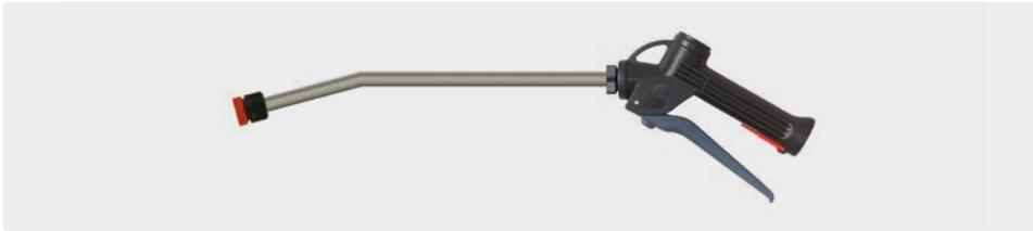
300 мм. Пистолет с копьем из нерж. стали и форсункодержателем без форсунки. Пистолет с химически стойким шариком из нерж. стали V4A / AISI 316. Макс. 25 bar / 30 л/мин / 50 °C
