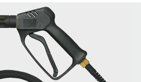
Пистолет с удлинителем 340 мм, макс. 210 bar / 25 л/мин / 150 °C. Вход / Выход HV M22. Шланг: Flexy с 1 проволочной оплеткой, макс. 300 bar / 100 °C
