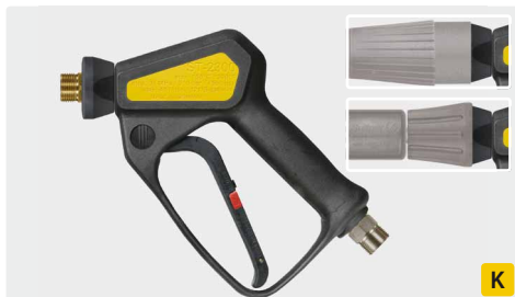
Пистолет с изолированным выходом подходит для копий с вращ. резьб. соед. Макс. 310 bar / 45 л/мин / 150 °C
