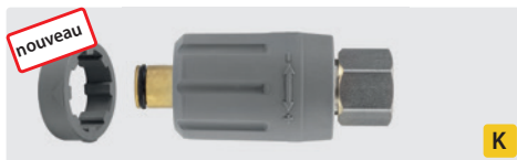
TR22 F : 3/8" F. Rotatif. Variante pour adaptateur 12. Laiton. Incl. 1 garniture de protection. Max. 400 bar / 150° C
