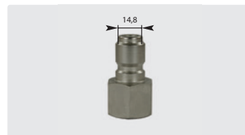
Штекер : IG. ⊙ 14,8 мм. Оцинк. сталь. Макс. 250 bar / 100 °C
