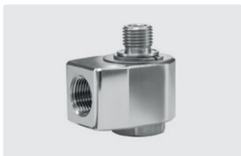
3/8" IG : 1/4" AG. DN 7. Макс. 150 bar / 30 об/мин / 90 °C
