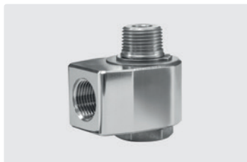
3/8" IG : 3/8" AG. DN 7. Макс. 275 bar / 30 об/мин / 120 °C
