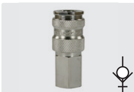
Муфта : IG. Никелир. латунь. С вентилем. Макс. 35 bar / 100 °C
