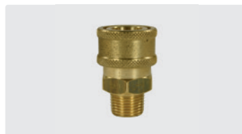
Муфта : AG. Латунь. Макс. 250 bar / 100 °C
