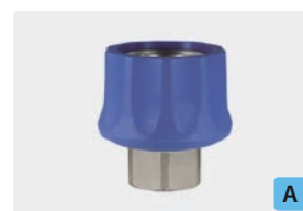
Муфта : IG. Никелир. латунь. Макс. 250 bar / 150 °C
