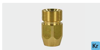
M22 AG : IG. Латунь. Изнутри шестигр. Макс. 400 bar
