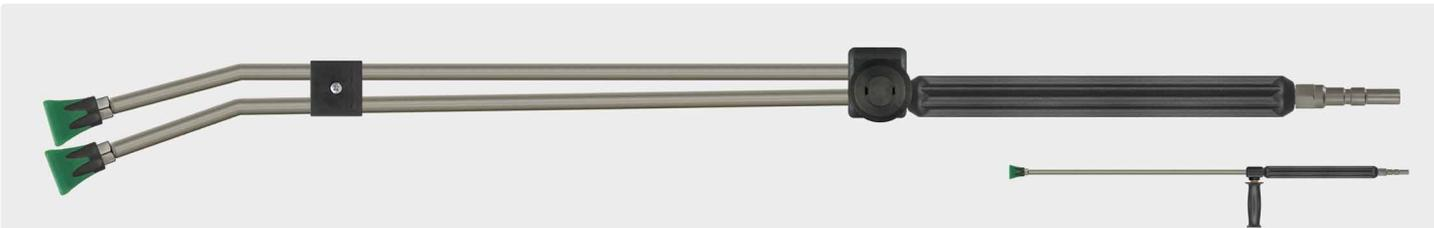
Штекер KW. Копье из нерж. стали, с нанесенной изоляцией 300 мм, вентиль ST-54 сбоку и защитой форсунки ST-10 с форсункой НД и муфтой 1/4" IG. Макс. 310 bar / 150 °C
