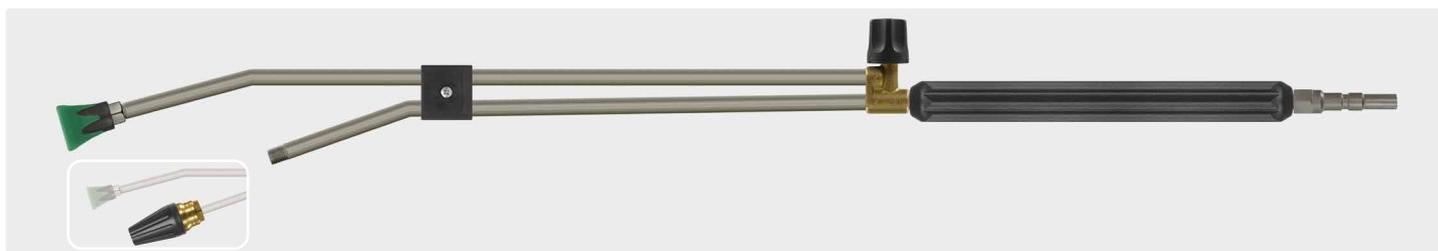
Штекер KW. Копье из нерж. стали, с нанесенной изоляцией 300 мм, вентиль ST-53 сверху, защита форсунки ST-10 с форсункой НД и 1/4" AG для роторной форсунки. Копья поставляются без роторных форсунок. Макс. 250 bar / 150 °C
