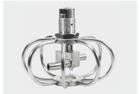
TYR-2f нерегулируемый. Мойщик труб с прямыми ротор. кроншт. для радиально действующего угла распыления. Идеал. подходит для мойки верт. колодцев. Полностью из нерж. стали. Вход 3/8" IG. Комплект поставки без форсунок. Необходимы 2 форсунки с 1/8" AG.
