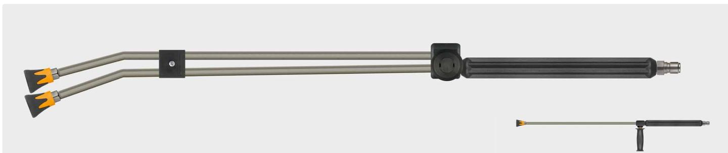
Штекер ST-3100. Копье из нерж. стали, с нанесенной изоляцией 300 мм, вентилем ST-54 сбоку и защитой форсунки ST-10 с форсункой НД и муфтой 1/4" IG. Макс. 310 bar / 150 °C
