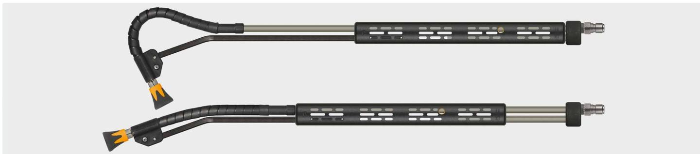
Штекер ST-3100. Копье из нерж. стали, изоляцией ST-9 380 мм и защитой форсунки ST-10 без форсунки. Плавная регулировка угла поворота копья от 20 до 140°. Вы получаете любой угол без вывихов и усилий. Макс. 210 bar / 150 °C
