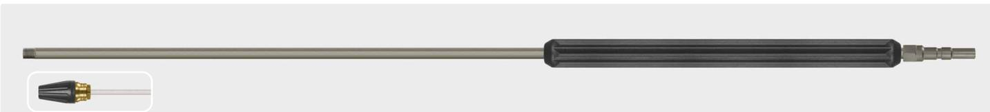
Штекер KW. Копье из нерж. стали, с нанесенной изоляцией 400 мм и 1/4" AG соединением для роторных форсунок. Копья поставляются без роторных форсунок. Макс. 400 bar / 150 °C
