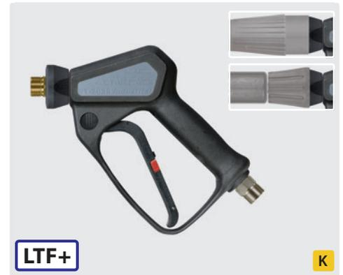
Пистолет с изолированным выходом подходит для копий с вращ. резьб. соед. Запатентованный ремкомплет для вентиля. Особо износостойкий шарик из закал. металла. Вращ. соед. комплектно из нерж. стали. Макс. 400 bar / 35 л/мин / 150 °C
