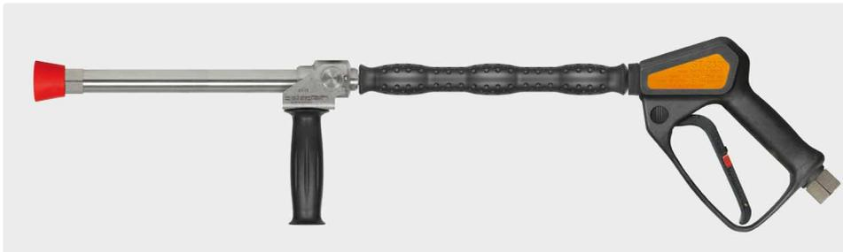
1/2" IG. Нерж. сталь. Копье с дальним выбросом 350 мм с изоляцией ST-29 Cool & Compact 330 мм, пистолетом ST-2320, боковой ручкой и защитой форсунки из пластмассы без форсунки. Макс. 150 bar / 80 л/мин / 100 °C
