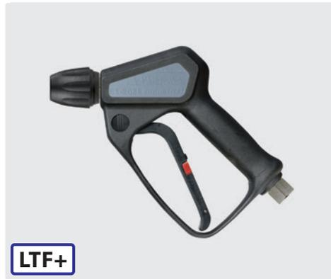
Профес. пистолет с муфтой KW. Запатентованный ремкомплет для вентиля. Особо износостойкий шарик из закаленного металла. Вращ. соед. комплектно из нерж. стали. Муфта KW из нерж. стали. Макс. 400 bar / 35 л/мин / 150 °C
