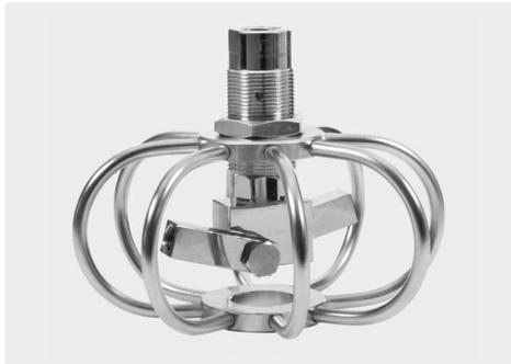
TYR-2s регулируемый. Мойщик труб с регулируемыми роторными кронштейнами для изменяемых углов распыления. Полностью из нерж. стал. Вход 3/8" IG. Комплект поставки без форсунок. Необходимы 2 форсунки с 1/8" AG. Макс. 275 bar / 120 °C. Макс. 275 bar / 120 °C
