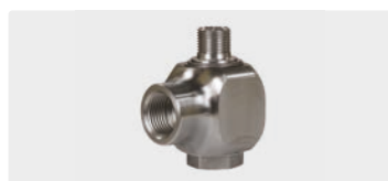
1/2" IG : 3/8" AG. DN 10. Макс. 300 bar / 90 °C
