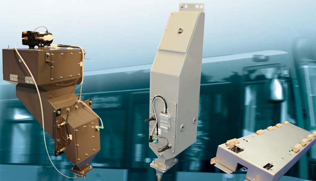
Песочная система PZKV поставляется с открытой архитектурой управления системой. Управление и контроль за ходом системы реализованы от вышестоящей системы управления трамвая, обычно с включением собственного блока управления как промежуточной ступени, который управляет ходом отдельных форсунок подачи песка и обеспечивает обратную связь и контроль для вышестоящей системы управления трамвая.
