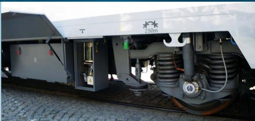
Смазочная система ОК-02 предназначена для смазки гребней тепловозов, оснащённых собственным источником и проводкой сжатого воздуха. Система работает на принципе нанесения смазочного средства на контактные поверхности гребней колёс тепловозов с рельсами посредством сжатого воздуха.
