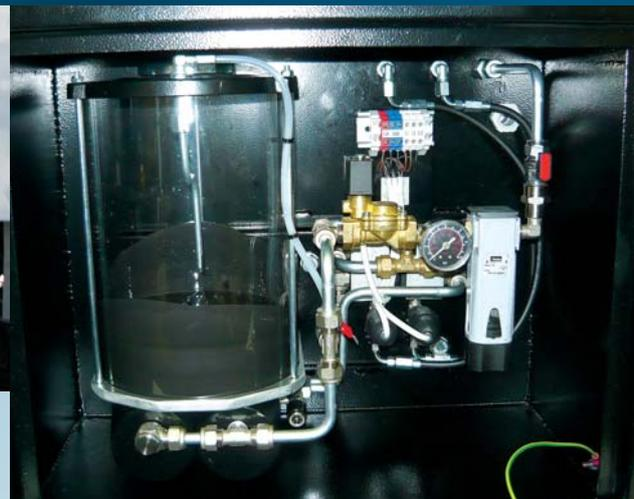
Система смазки гребней ОК-02 поставляется с открытой архитектурой управления системой, в трёх базовых уровнях способа управления и контроля за ходом системы:
